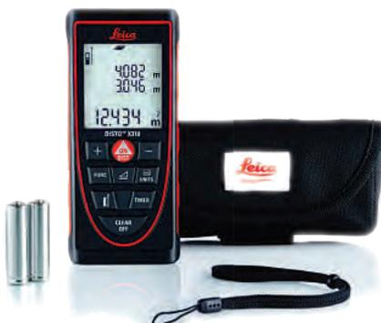
Strahlwassergeschütztes und staubdichtes Laserdistanzmessgerät gemäß IP65, zusätzlich getestet auf Stürze aus bis zu 2 m Höhe! Dank des integrierten Neigungssensors sind indirekte Distanz- und Höhenmessungen absolut präzise möglich.
