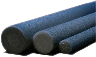
Rundprofilichtung für den Innen- und Außenbereich, die die Anforderungen der DIN 18 540 zur Dehnfugenausbildung erfüllt. Sie besteht aus geschlossenzelligem Polyethylenschaum und ist zum Abdichten von Zug- und Wärmeverlust geeignet.
