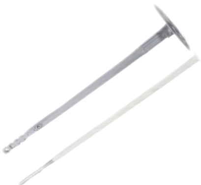
**Zugelassener Schlagdübel für die Montage in Beton und Mauerwerk.** Durch Einschlagen des vormontierten Compoundnagels mit dem Hammer wird der Dübel im Untergrund verankert. Der Compoundnagel vereint alle Vorteile eines Stahl- und Kunststoffnagels. Der Stahlnagel sorgt für eine optimale Spreizung und der Schaft aus glasfaserverstärkten Kunststoff ist nahezu wärmebrückenfrei und hilft, Energie zu sparen.
