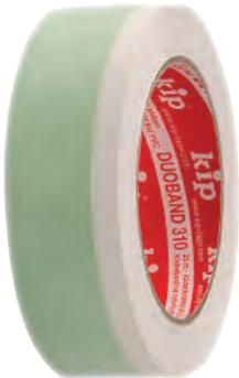
Das doppelseitige Klebeband, bestehend aus einer widerstandsfähigen und schmiegsamen Weich-PVC-Folie, ist an einer Seite teilweise beschichtet und ermöglicht das einfache Entfernen des silikonisierten Trennpapiers. Das Klebeband ist anwendbar für innen und außen.
