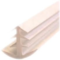
Das Dehnfugen-Abdeckprofil dient zur Abdeckung von vertikalen Bewegungsfugen zum Schutz vor Witterungseinflüssen, zur Vorbeugung von Verletzungen an der Schlaufe bzw. aus optischen Gründen. Es ist für Fugen auf der Fassadenfläche und für Fugen in Innenecken verwendbar. Das Dehnfugen-Abdeckprofil ist UV-resistent, schlagregenfest und überstreichbar.
