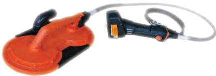
WDVS-Schleifer mit 2 Power-Akkus zum Planschleifen von WDVS-Platten. Optimal geeignet für Arbeiten auf dem Gerüst. Absaugstutzen für Staubabsaugung vorhanden. Produktvorteile sind völlige Bewegungsfreiheit, kein störendes Kabel, lauf ruhig durch gegenläufige Werkzeugscheiben.
