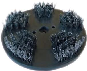
Eine besondere Spezialität des ROKAMAT-Universal ist die Reinigung von Schalelementen. Betonreste auf einer oberflächenbeschichteten Schalhaut oder am Stahlrahmen lassen sich mühelos durch Stahlbürsten entfernen. Wird die Schalhaut anschließend mit Nylonbürsten eingewachst, ist sie für viele weitere Schaleinsätze bestens präpariert.
