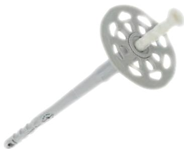
**Der wirtschaftliche Schraubdübel für alle Dämmstoffarten und für alle Nutzungskategorien.** Schnelles, einfaches Setzen mit einem handelsüblichen Bohrhämmer oder Akkuschauber. Die spezielle Compound-Schraube ermöglicht die thermische Trennung zwischen Stahl und Kunststoff.
